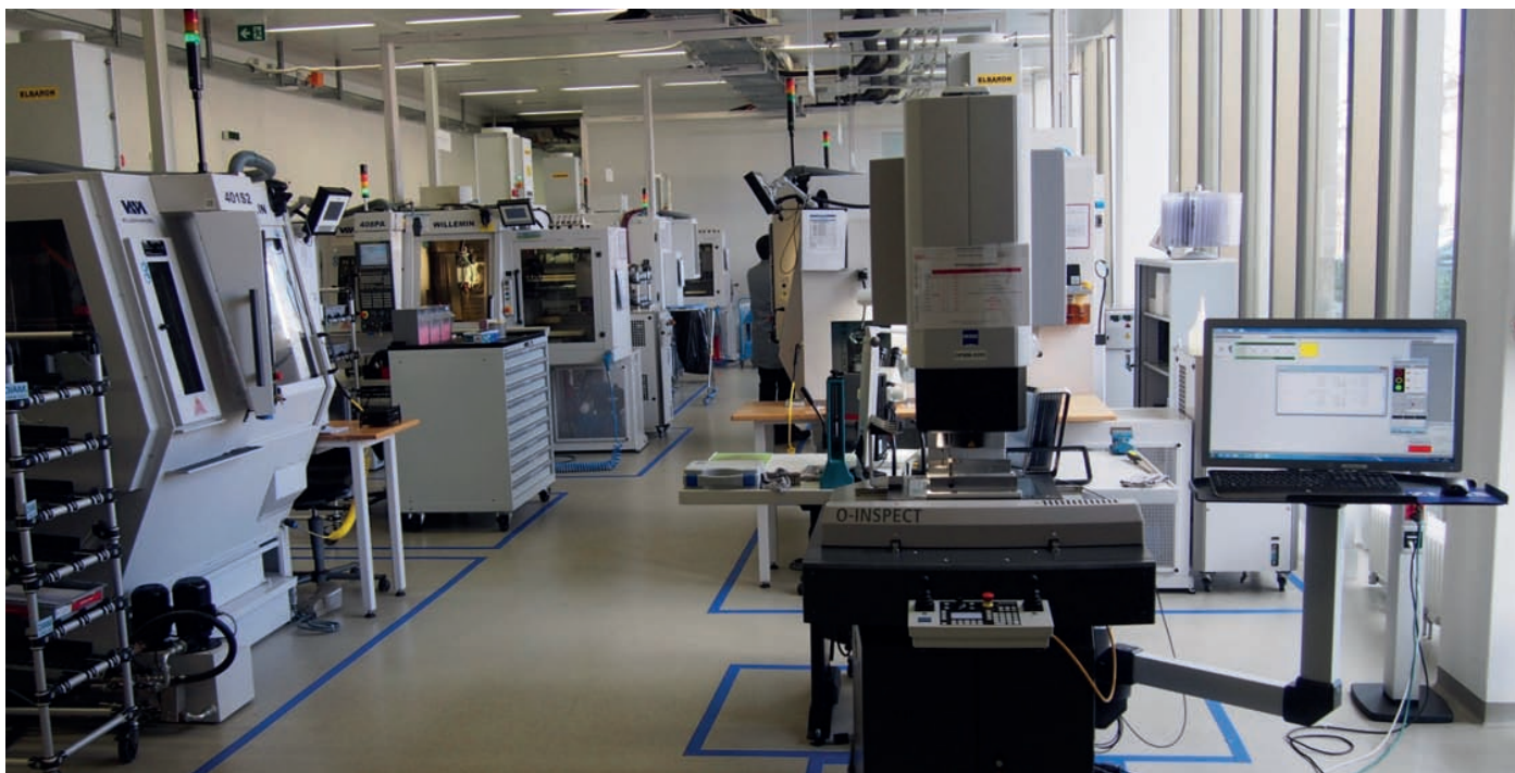
➤ Vue de l’atelier de production composé de centres d’usinage haut de gamme et de machines Zeiss pour du contrôle en production
